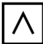
Рисунок 512 — Графический элемент «Пожарный автоматический пламени»
