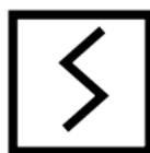
Рисунок 510 — Графический элемент «Пожарный дымовой автоматический извещатель»
