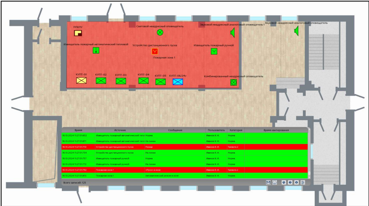
Рисунок 66 — Проект «TX SCADA» в режиме работы ИМ, созданный с использованием драйвера Лидер-А
