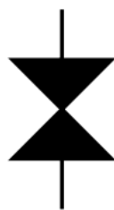
Рисунок 455 — Графический элемент «Запорная арматура»
